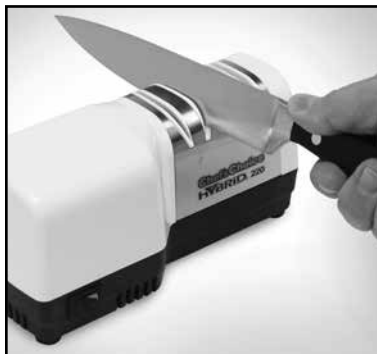
Kuva 3 Veitsen asettaminen oikeanpuoleiseen hahloon vaiheessa 1. Teroita vuorotellen vasemman- ja oikeanpuoleisissa lohkoissa
