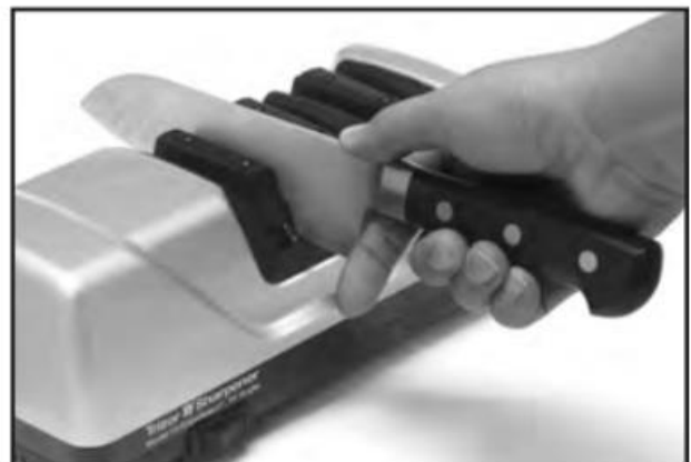
Kuva 14. Jos veitsessä on iso väli, niin sormen asettaminen siihen voi auttaa teroittaessa. Kuva 15. Aseta etusormesi väliin ja aseta veitsi teroitushahloon (katso ehdotus nro. 8)
