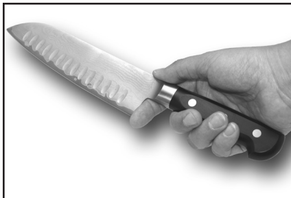
Kuva 14. Jos veitsessä on iso väli, niin sormen asettaminen siihen voi auttaa teroittaessa.
