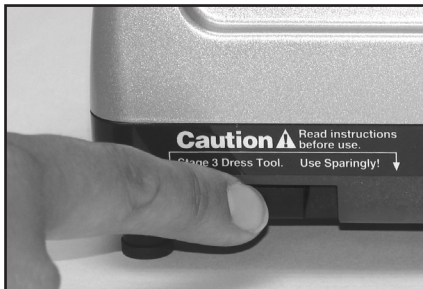
Рисунок 13. Используйте функцию очистки доводочного шлифовального диска экономно (инструкции приведены ниже).
