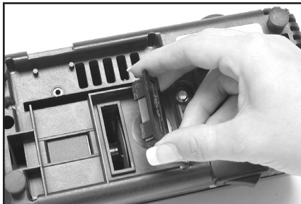
Bild 16. Ta bort locket på undersidan av slipen för att putsa bort metalldamm som samlats i slipen (se underhållsanvisningarna)
