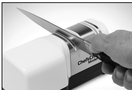
Joonis 1. Noa asetamine vasakusse 1. etapi sätku.
