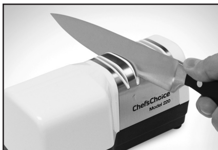
Kuva 3 Veitsen asettaminen oikeanpuoleiseen hahloon vaiheessa 1. Teroita vuorotellen vasemman- ja oikeanpuoleisissa lohkoissa
