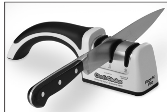
Kuva 3. eurooppalaiset tai amerikkalaiset veitset 20° teroitetaan ensin vaiheessa 2 ja viimeistellään vaiheessa 3 (kuva 4)
