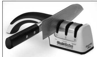
Kuva 1. aasialaistyyliset veitset (15°) teroitetaan ensin vaiheessa 1 ja viimeistellään vaiheessa 3 (kuva 2)
